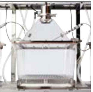
Homogeneous aerosol distribution エアロゾルの均一分散が可能
